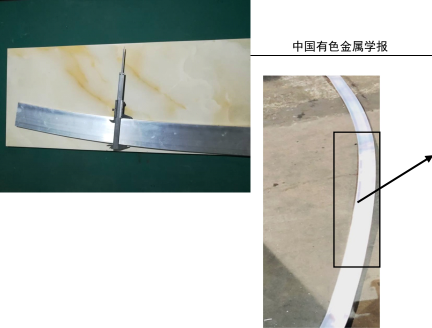
图 13 工业级挤压试验获得的弯曲板材。
