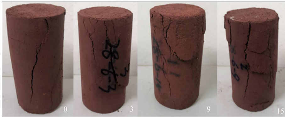
图4 养护28 d固结体单轴压缩破坏图
