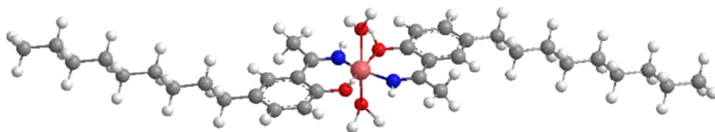
图 3 Versatic 10/Mextral 84H 体系下钴萃合物可能的空间结构
