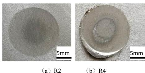
图 14 不同电极圆角半径时焊点表面形貌
