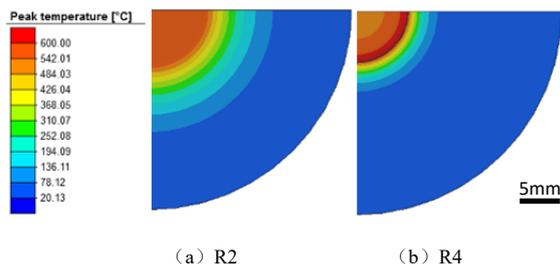
图 13 7ms 时不同圆角半径下工件表面温度
