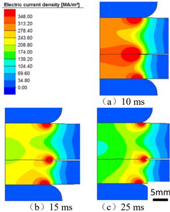
图 7 不同时间下工件中电流密度
