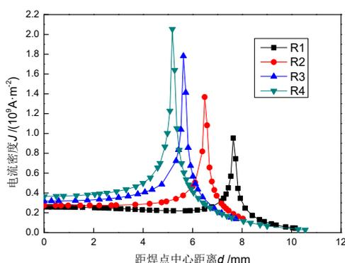
图 12 7ms 时不同圆角半径下工件表面电流密度
