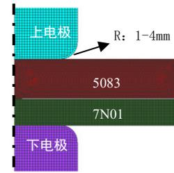
图 1 电阻点焊有限元模型
