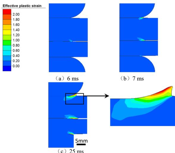
图 11 4 mm 圆角电极点焊过程中母材等效应变分布云图
