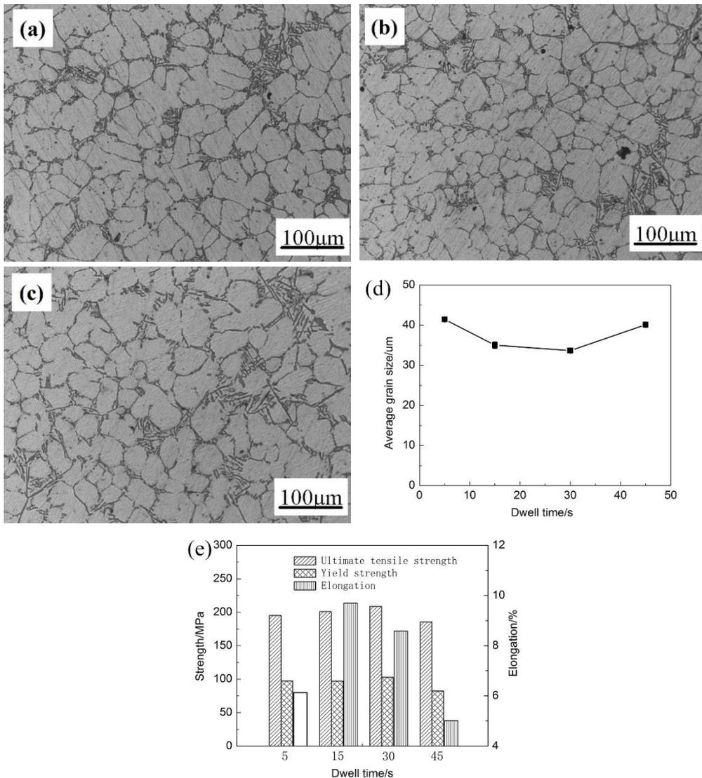
图 10 不同保压时间下挤压铸造件的微观组织、平均晶粒直径及力学性能
