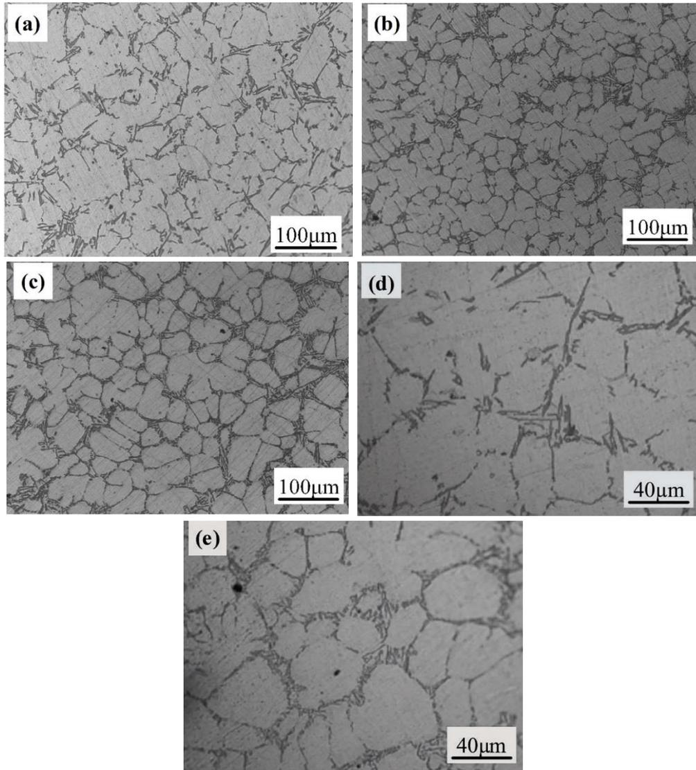
**图3** 不同成形方式的制件的微观组织
