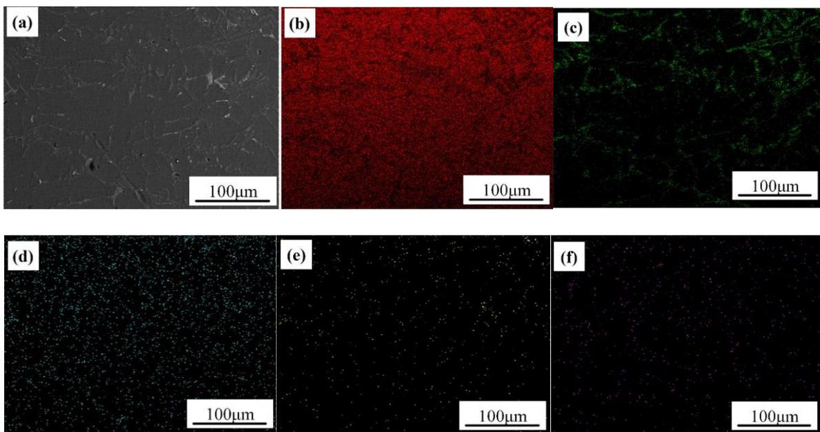
图 12 挤压铸造件(表 2 中实验号 9 号条件)的面扫描能谱图
