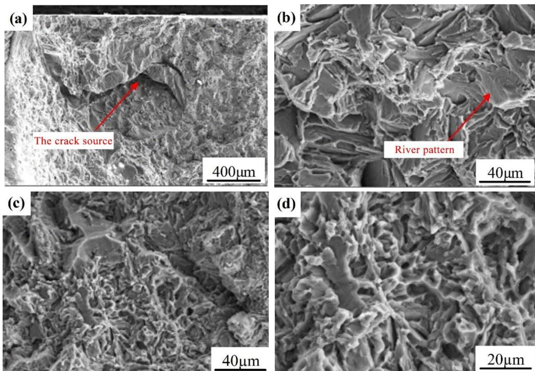
图 6 重力铸件和挤压铸造成形件(表 2 中实验号 15 条件)的断口形貌对比
