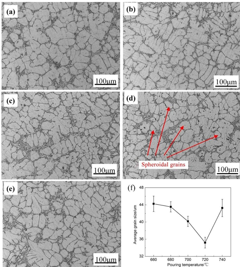
**图7** 不同浇注温度下的挤压铸造件的微观组织以及平均晶粒
