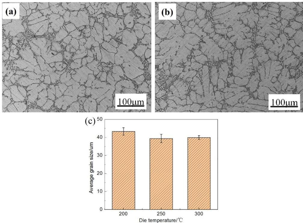
图 9 不同模具温度下挤压铸造件的微观组织以及平均晶粒直径
