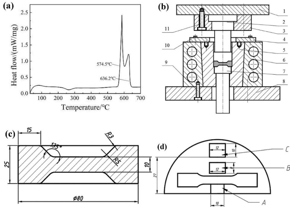
图1 AlSi7Mg 铝合金 DSC 曲线、构件挤压铸造模具结构、零件图及取样位置
