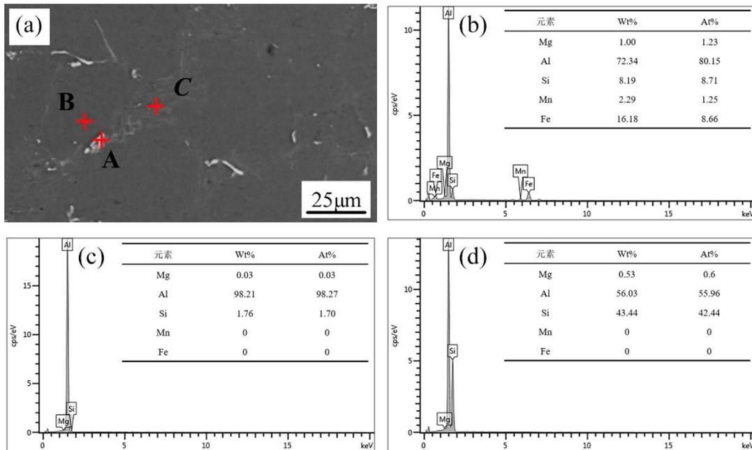
图 11 挤压铸造成形件(表 2 中实验号 15 条件)点扫描能谱图
