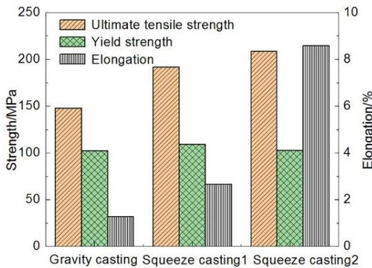
图 5 不同方法成形的 AlSi7Mg 铝合金构件的力学性能对比
