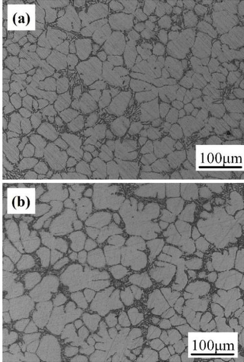
图 4 在表 2 中实验号 15 条件挤压铸造成形件不同位置的微观组织
