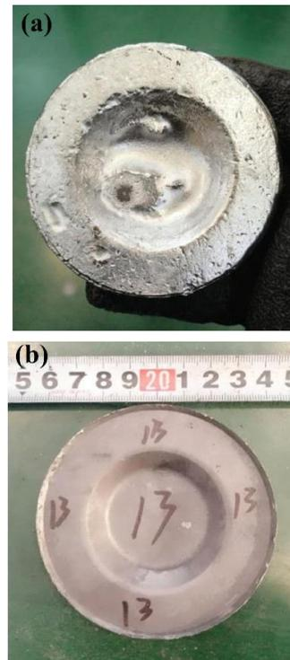
图2 重力铸造件和挤压铸造成形件的宏观形貌
