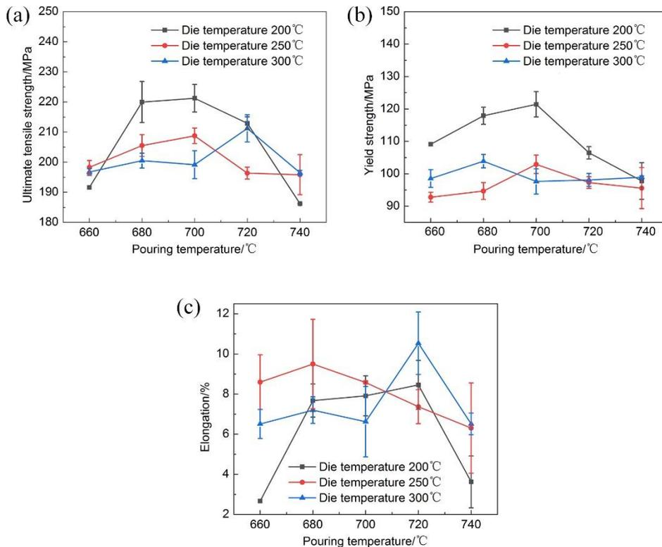
图8 不同浇注温度下挤压铸件的力学性能
