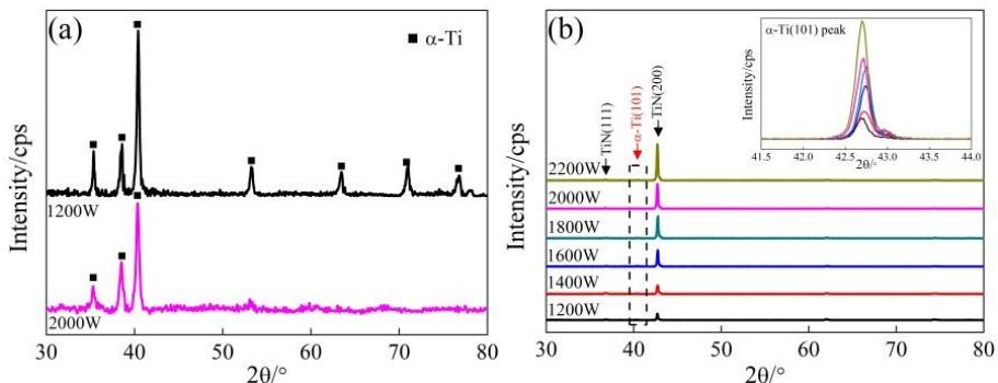
图 4 不同激光功率下硬化层与氮化层表面的 XRD 图谱
