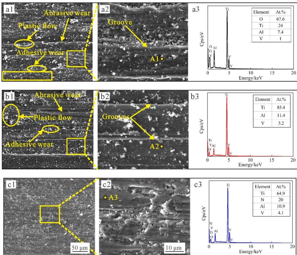
图 10 基体、硬化层与氮化层的磨痕 SEM 形貌与 EDS 能谱
