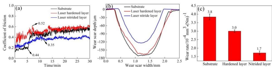
图 9 基体、硬化层与氮化层的磨损结果
