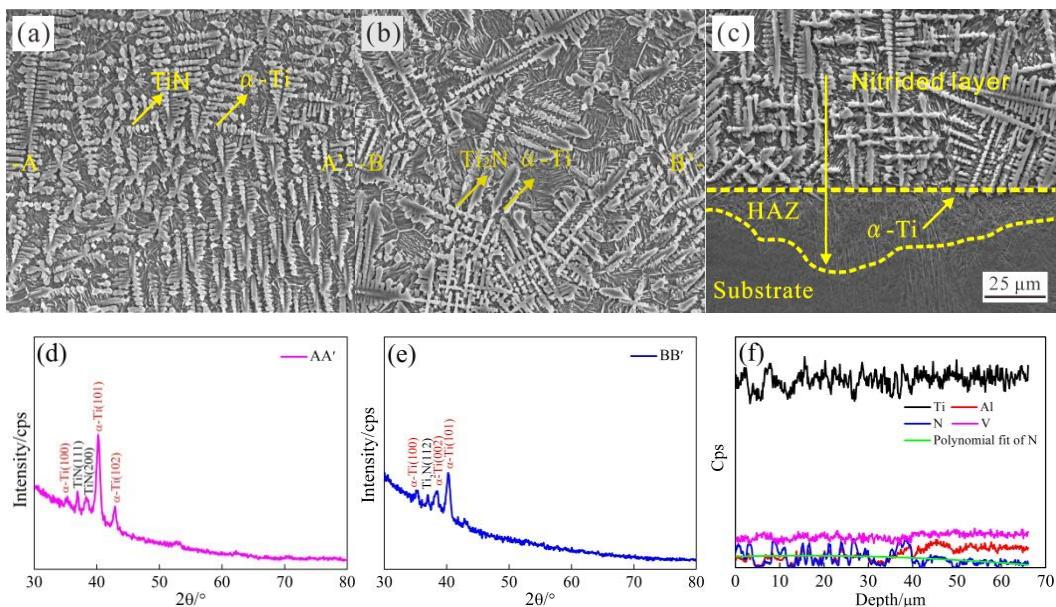
图 72000 W 功率下氮化层不同层深位置组织、相组成及线扫描结果
