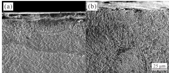
图 5 不同激光功率下硬化层表层截面组织
