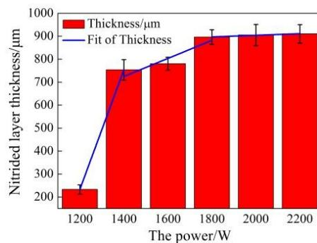
图 2 不同激光功率下氮化层层深
