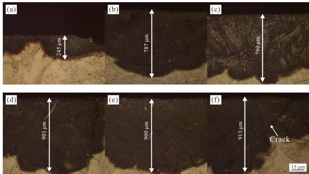
图 1 不同激光功率下氮化层截面组织
