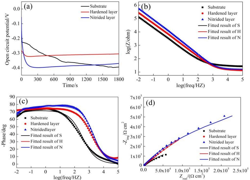
图 11 基体、硬化层与氮化层在 3.5%NaCl 溶液中的测试结果
