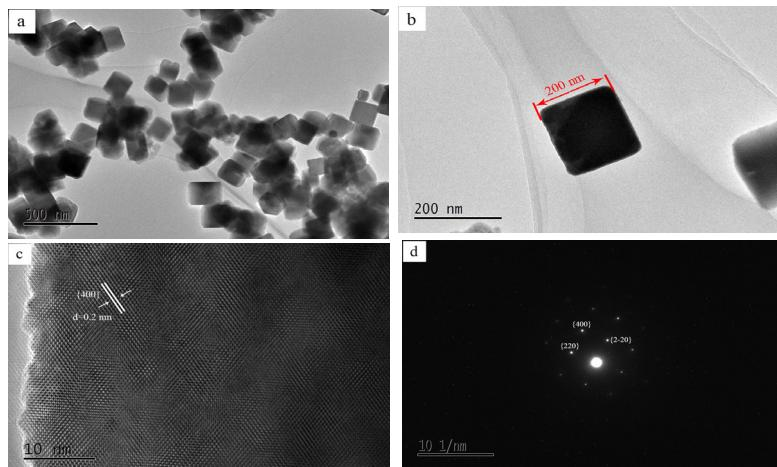
图 6 水热处理样品  $\text{Co}_3\text{O}_4$  的 TEM 图片 (a、b) TEM ; (c)HRTEM 和(d)SAED 图
