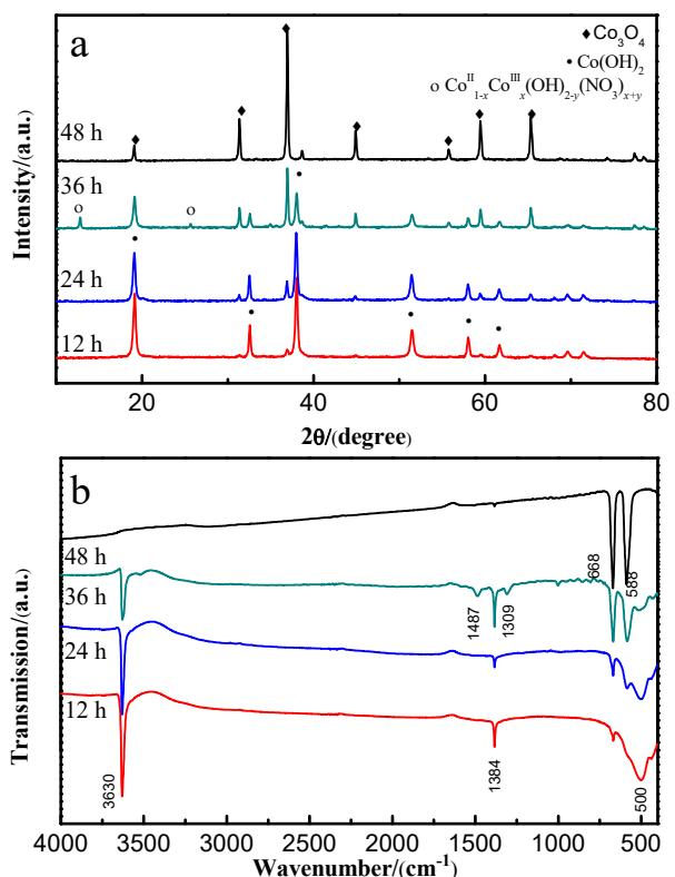
图 3 不同水热时间下获得产物的 (a) XRD 和(b) FT-IR 谱
