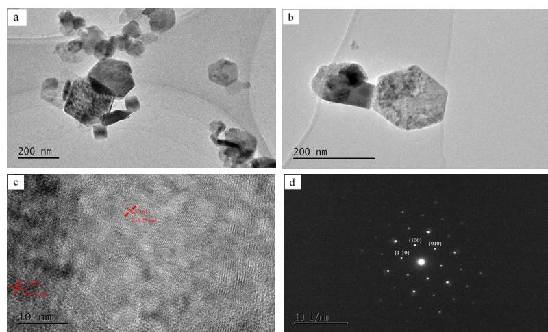
图 5 水热处理样品  $\text{Co}(\text{OH})_2$  的 TEM 图片 (a、b) TEM ; (c)HRTEM 和(d)SAED
