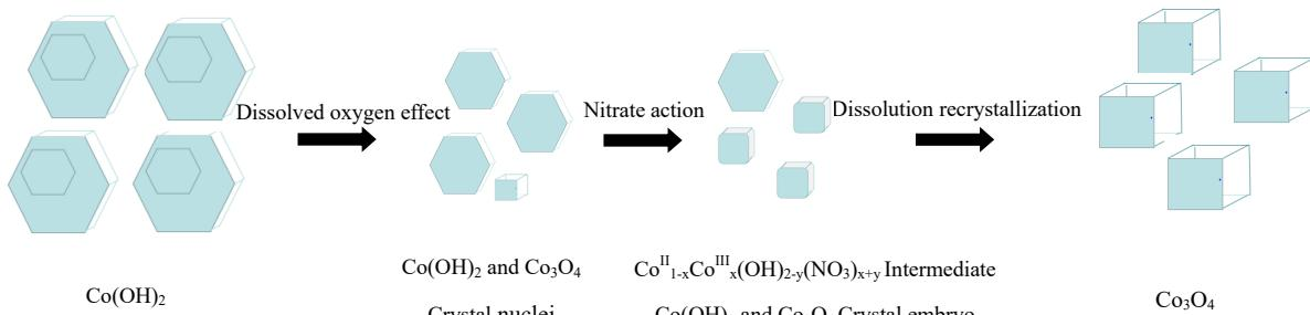
图 7 产物形貌演变示意图
