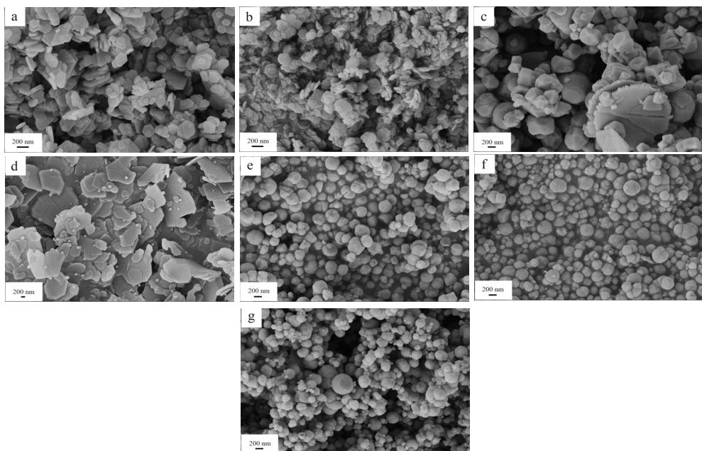
图 2 不同原料配比下合成样品的 SEM 图
