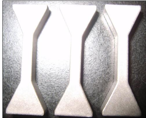
图4 1 440 °C 烧结时抗拉试样的照片
