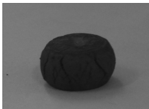
图 6 \text{Al}_2\text{O}_3/\text{Cu-WC} 复合材料热变形中的宏观照片
