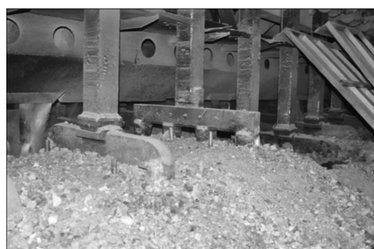
图 16 在电解槽上生产的穿孔阳极
