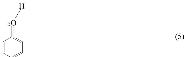
由式(4)~(5)可知, 活性炭中羟基氧原子sp<sup>3</sup>轨道中存在的孤对电子, 可与苯酚中羟基中的氢形成氢键, 苯酚吸附在活性炭上的结构为
