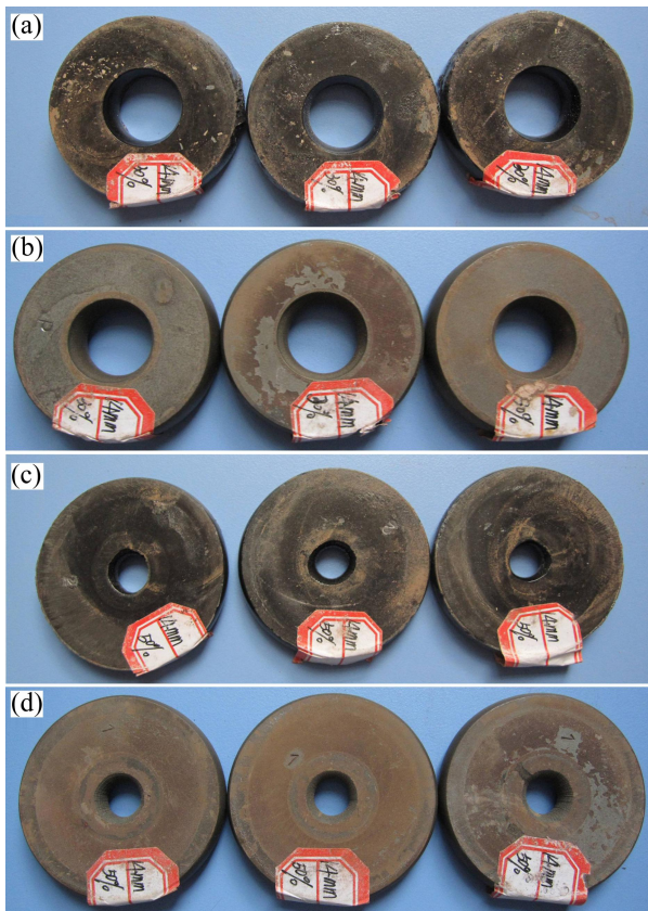
图1 不同条件下圆环镦粗试样照片
