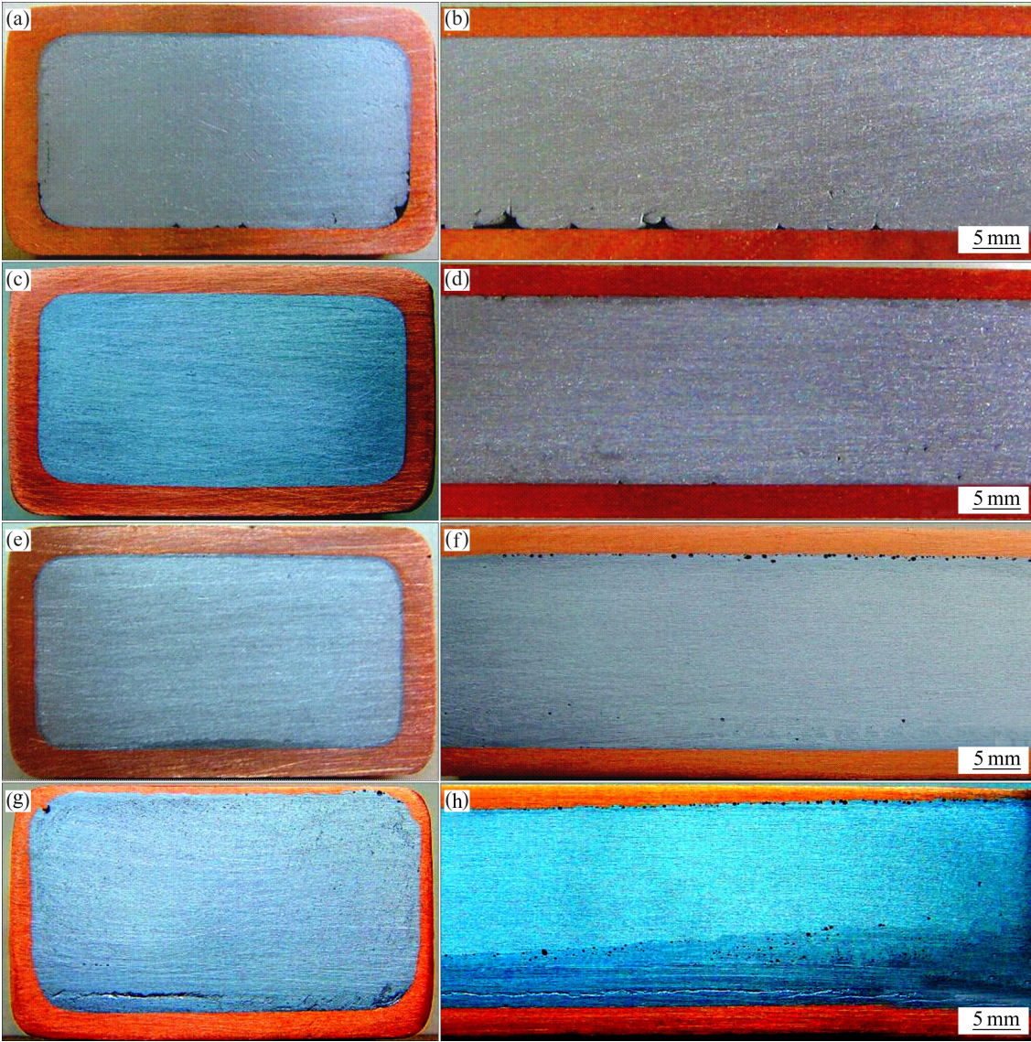
图 3 不同拉坯速度下所制备的矩形铜包铝复合材料横、纵断面的宏观形貌
