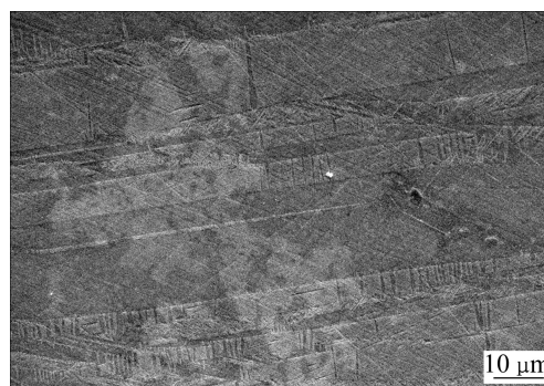
图 3 腐蚀前 Cu-12%Al 合金的表面形貌
