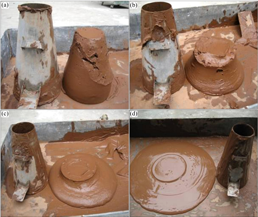
图 4 试样坍落度测试照片
