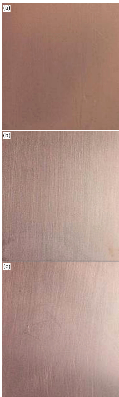
图 4 浸泡 80 d 后 3 种阳极氧化膜的表面状态
