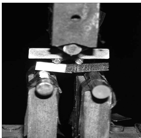
图7 C/C-Cu 连接接头四点弯曲断裂形貌
