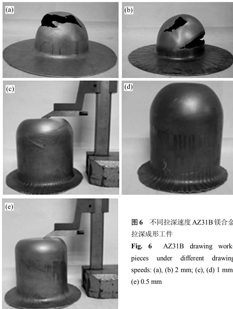
图 6 不同拉深速度 AZ31B 镁合金拉深成形工件
