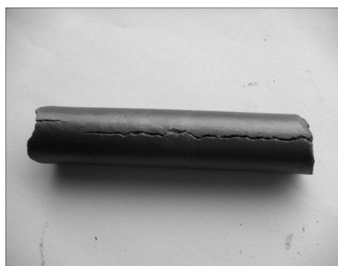
图 4 溶剂脱脂过程中的棒坯开裂
