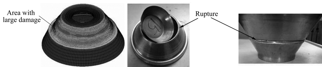
图 10 第 1 道次旋压过程中的非筋部破裂
