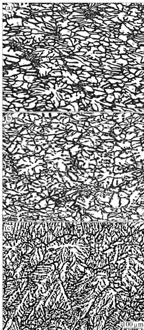
图5 不同浇注温度下位置2的镁合金组织
