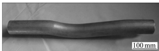
图 8 内压为 2.8 MPa 时的合格试件
