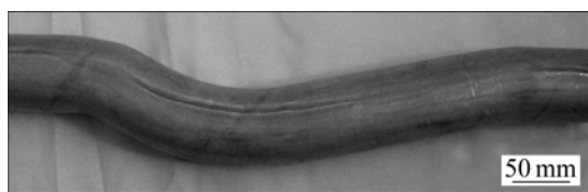
图 5 内压为 3.2 MPa 时分模面处飞边
