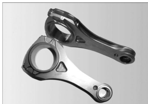
图2 钛制汽车连杆照片
