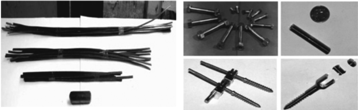
图 2 采用 ECAP 法制备的纯钛纳米化材料及典型骨钉样品
