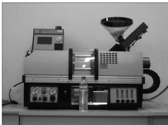
图 1 微注射成型机 BABYPLAST
