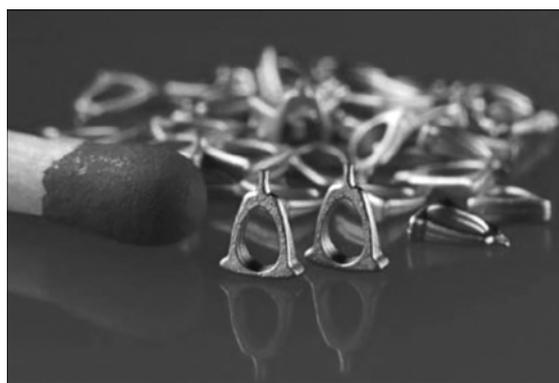
图3 微注射成型技术制备听小骨中的蹬骨
