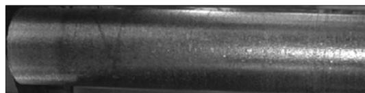
图5 电子束冷床熔炼炉生产的铸锭表面质量
