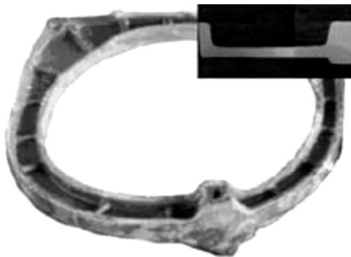
图6 TA15大型整体钛框等温模锻件照片
