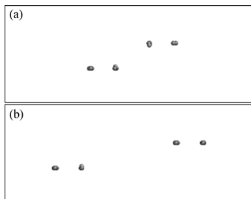
图 3 刃位错偶中的两根位错在外加切应力作用下在基面开动
