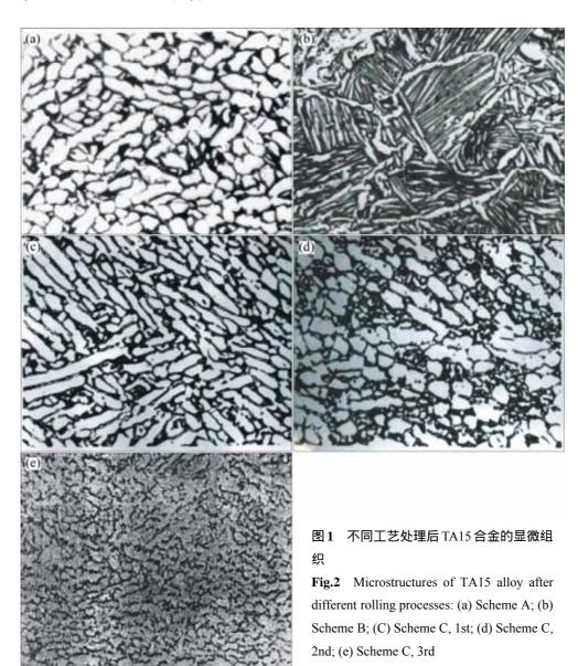
程度的拉长、扭曲和破碎,经过随后的再结晶退火处理,晶粒呈短板条状。
