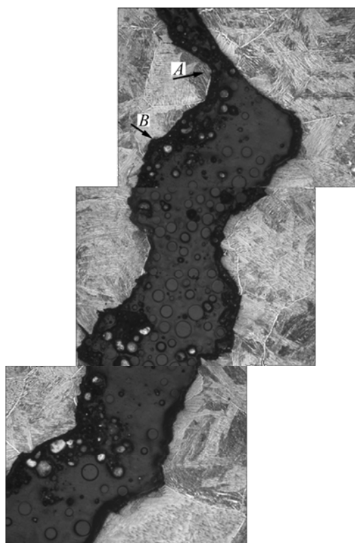
图5 TC21 合金在断裂韧性测试中裂纹扩展路径
