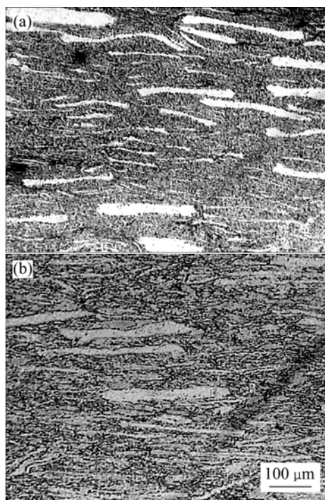
图4 退火态氧化粉末合金和雾化粉末合金显的显微组织
