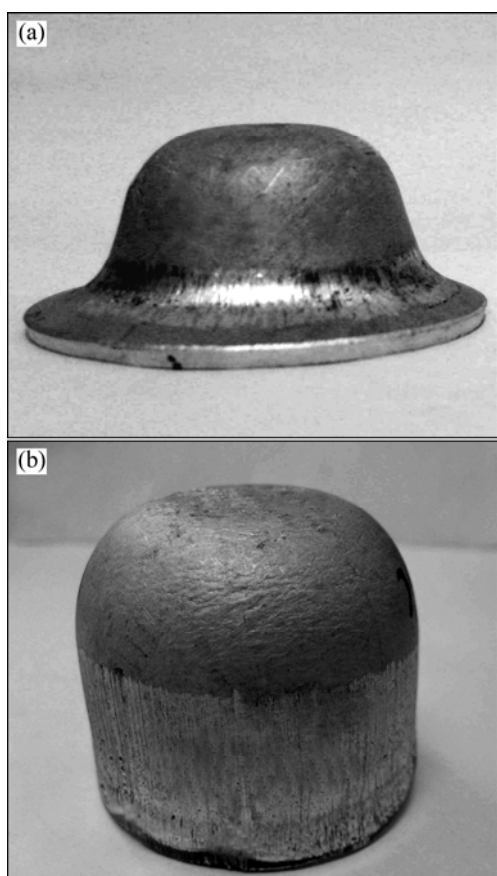
图 4 预变形对铸轧镁合金极限拉深比的影响
