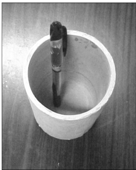
图 3 凝胶注模成型的 \beta\text{-Si}_4\text{Al}_2\text{O}_2\text{N}_6\text{-0.5SiO}_2 陶瓷坩埚坯体照片(容量约 500 mL) [48]
