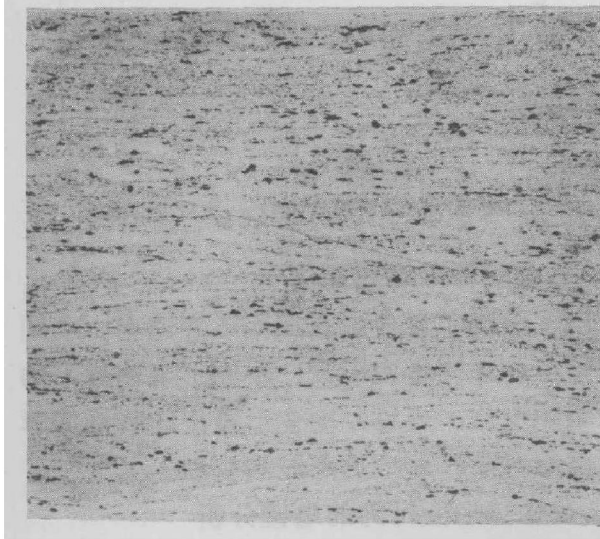
图4 500\text{ }^{\circ}\text{C} 顶锻后的显微组织( \times 85 )
