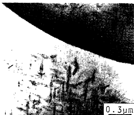
图4 晶界近傍的S'无析出带
