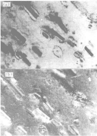
图 1 LY12 合金自然时效状态 TEM 照片 (a)—明场像; (b)—暗场像
