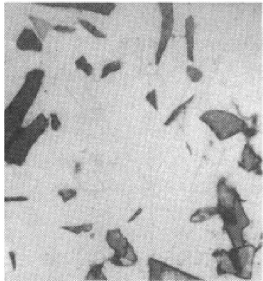
图 5 6066Al/SiC p 沉积坯的界面状态, \times 100
