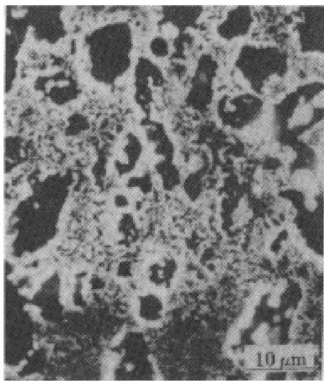
图5 40% Ti层 FGM 的 SEM 形貌
