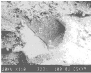
图 3 触媒合成片上残留的金刚石晶体生长坑
