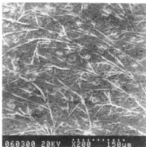
图1 无机硅酸钠亲水膜 SEM 照片
