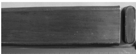
图 12 铜包铝扁排表面及断面形貌
