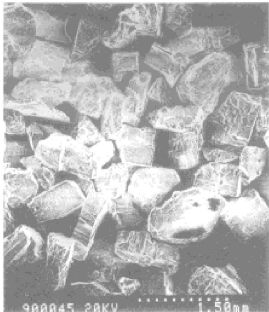
图 2 焙烧前预制块颗粒形貌
