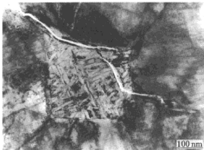
图5 裂纹沿晶扩展及晶间 \beta 发生转变形貌
