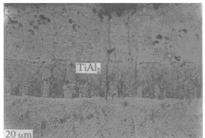
图 2 TiAl 渗 Al 涂层 1000 °C 氧化 100 h 后的横截面显微组织
