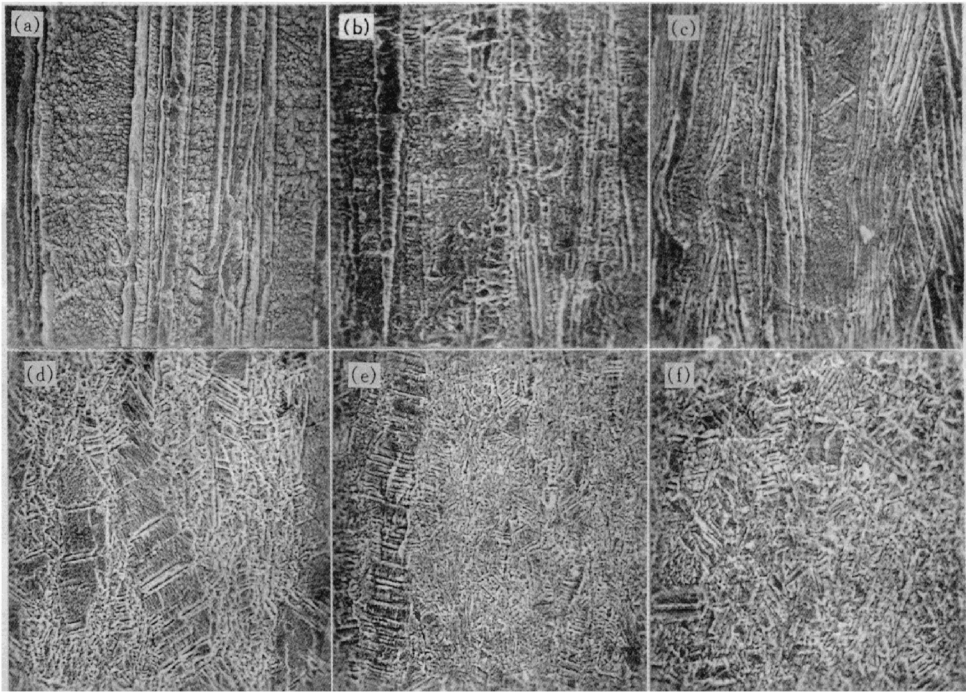
图 6 不同硫脲浓度时铜沉积的横截面 SEM 照片
