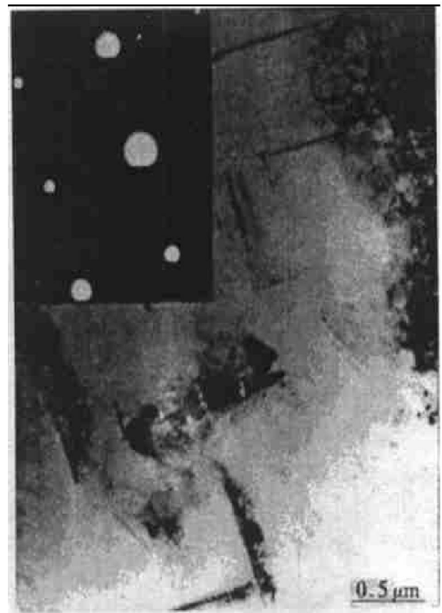
图2 铸态组织中的针状 Mg_2Si 相
