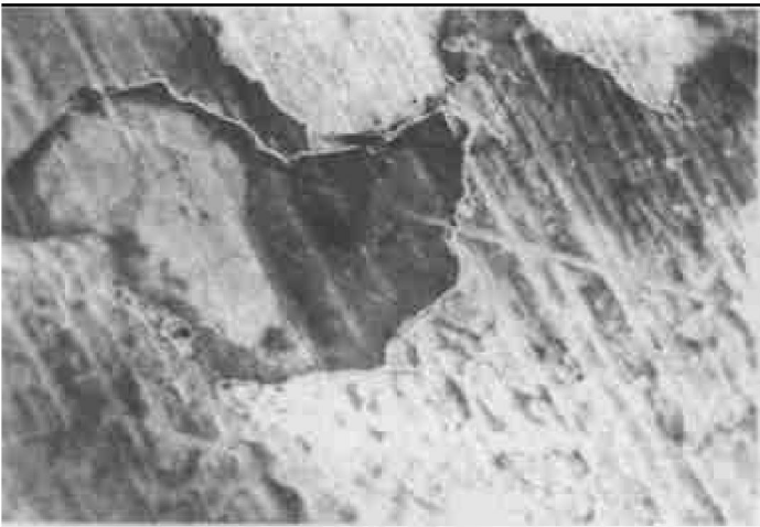
图 5 3Cr2W8V 在 600 °C氧化的 SEM 形貌 Fig. 5 SEM morphology of 3Cr2W8V oxidized at 600 °C
