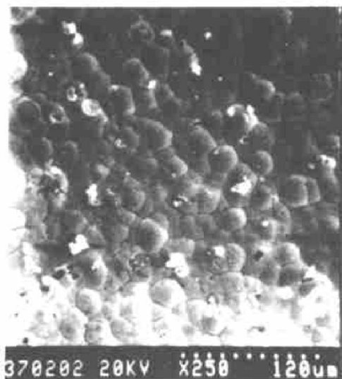
图4 A 30 电极化学复合镀中间层形貌
