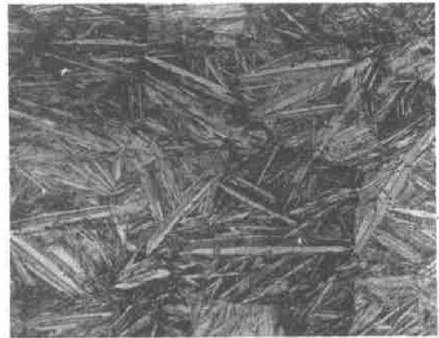
图 4 试验合金的热弹性马氏体组织 (×100)
