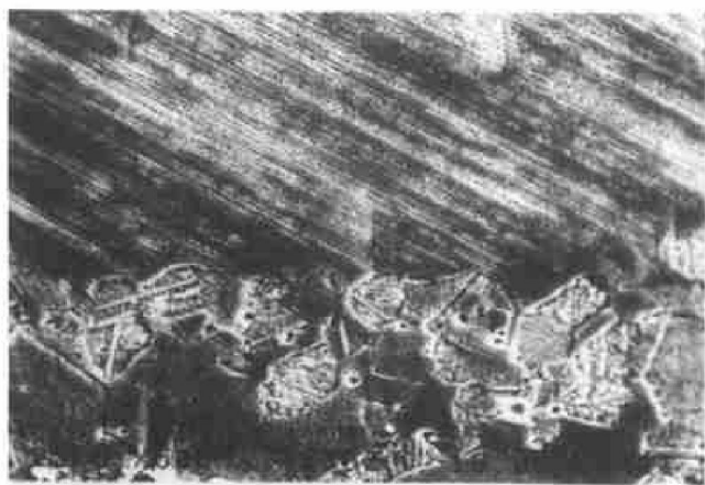
图 6 排气阀菌部与铸态杆部联接界面处的显微组织(×500)
